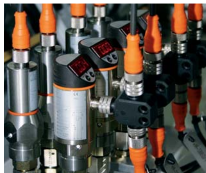
过滤监控中差压测量。
