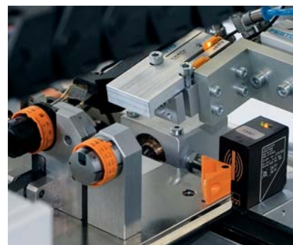
最终位置的安全检测，即使短气缸。
