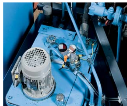
紧凑的液压动力机组中的液位或温度组合测量。
