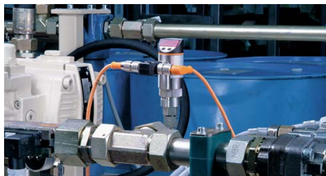
过滤监控中差压测量。
