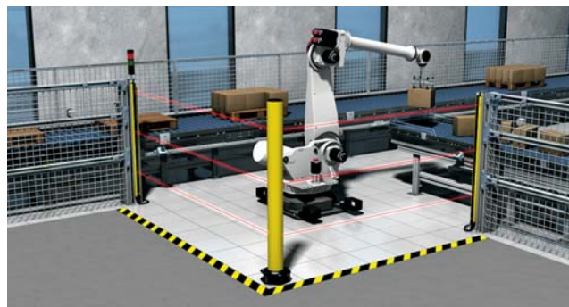
安全光栅保护机器人的工作区。
