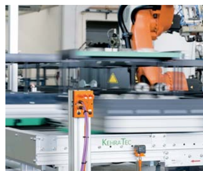
易福门电子新型RFID评估装置，带集成Profibus-DP接口和网络服务器广泛应用于生产中。
